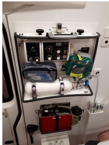
Medumat, Absaugpumpe, Mülleimer, Schere in Halterung
