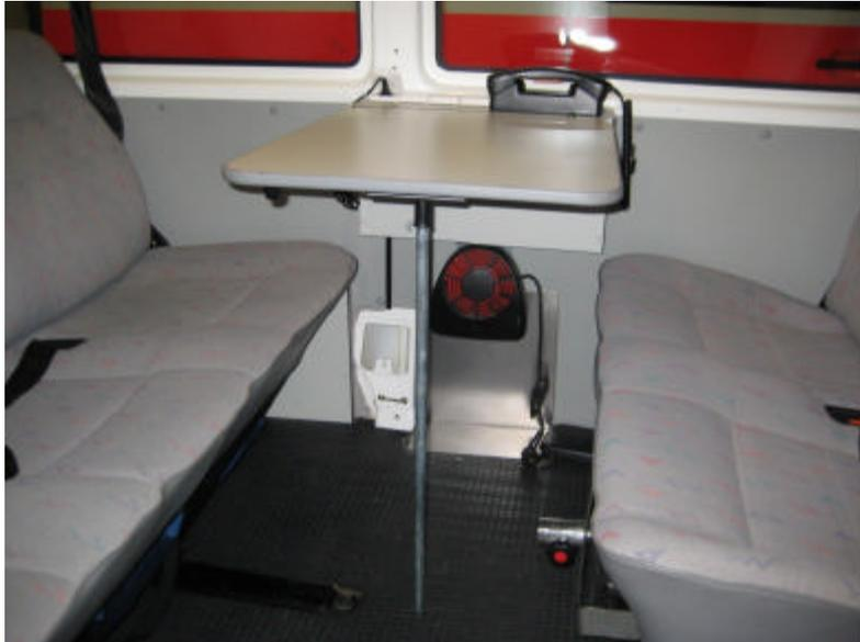
Der Tisch ist einklappbar, sodass z.B. bei längeren Fahrten mehr Beinfreiheit zur Verfügung steht. Unterhalb dieses Tisches ist ein Heizlüfter befestigt, der bei Bedarf für eine gute Lufttemperatur sorgt.
